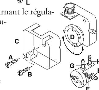
**Note:** La pression mesurée à la prise de pression E doit être comprise dans les limites de la plage de travail du pressostat. Sinon, dévisser l'écrou de blocage de la vis F et la tourner graduellement: à droite pour réduire la pression; à gauche pour l'augmenter. Enfin serrer l'écrou de blocage.
