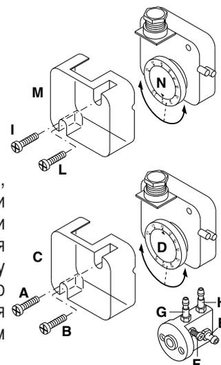
**Внимание:** Давление в гнезде **E** должно находиться в пределах рабочего диапазона реле. В противном случае ослабить блокировочную гайку винта **F**, затем вращая его (по часовой стрелке для уменьшения давления и против часовой стрелки - для его увеличения) произвести требуемое регулирование. По завершении регулирования затянуть гайку.
