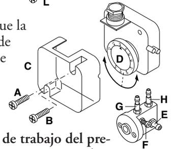
**Nota:** La presión medida a la toma del aire E debe estar dentro de los límites del campo de trabajo del presostato. En caso contrario, destornillar la tuerca de bloqueo del tornillo F y rodarlo progresivamente: a la derecha para disminuir la presión; a la izquierda para aumentarla. Al final atornillar la tuerca de bloqueo.
